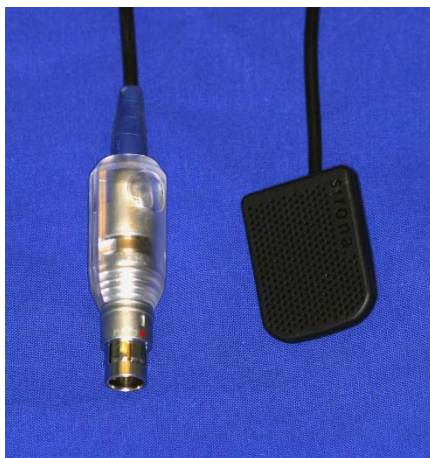
Abb.3 CCD-Sensor des Sidexis Intraoral Röntgen Systems, welcher über einen Stecker mit einer USB-Box verbunden wird, welche wiederum am PC angeschlossen ist. Die Röntgenstrahlung wird vom Sensor registriert und innerhalb von Sekunden entsprechend dem Strahlenrelief am Monitor dargestellt.
