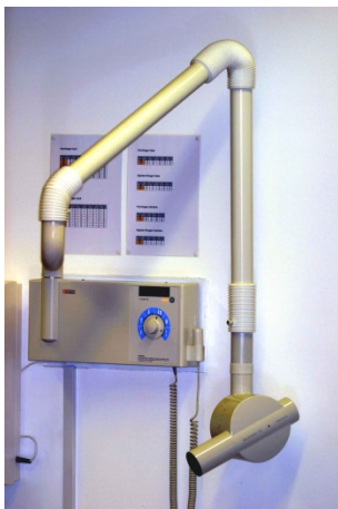
Abb. 1: Dentales Kleinröntgengerät mit 60kV und 7mA. Über einen beweglichen Wand- oder Deckenarm sowie eine Skala für die Tubusneigung kann die gewünschte Projektion eingestellt werden.
